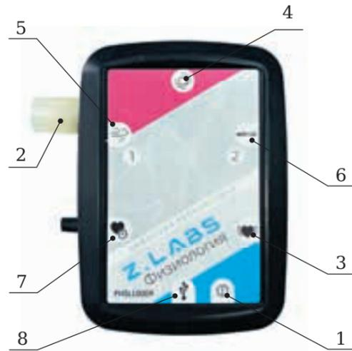
Рисунок 4.2.1. Беспроводной мультидатчик по физиологии:
